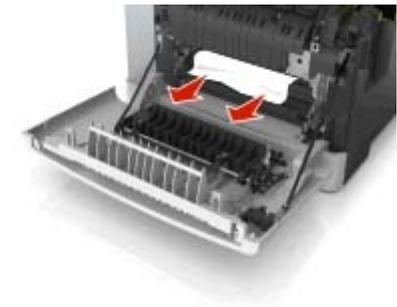
b Ziehen Sie den grünen Hebel, um die Abdeckung der Fixierstation zu öffnen.
