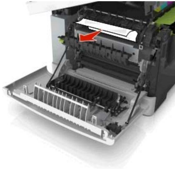
4 Verschieben und halten Sie die Entriegelung an der rechten Seite des Druckers, und schließen Sie dann langsam die obere Klappe.
