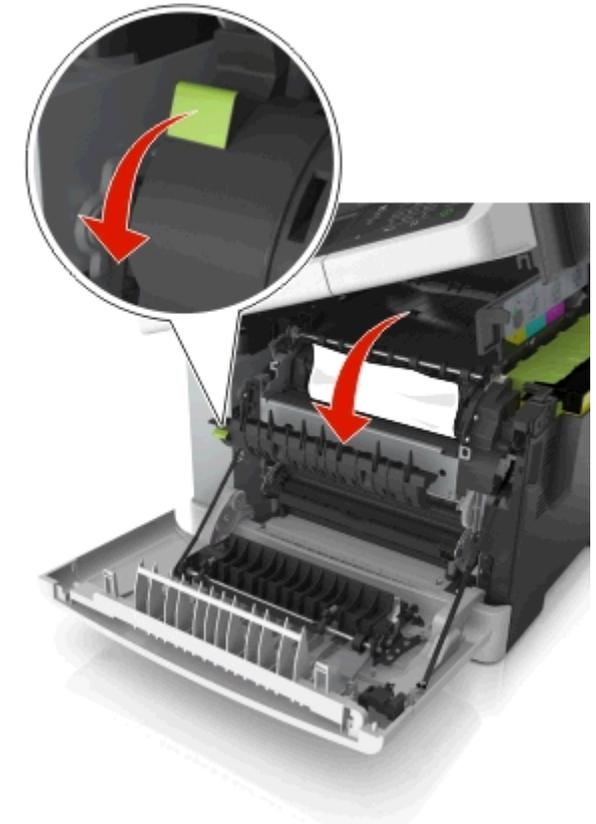
c Wenn das Papier in der Fixierstation gestaut ist, halten Sie die Abdeckung der Fixierstation nach unten, und entfernen Sie das gestaute Papier.
